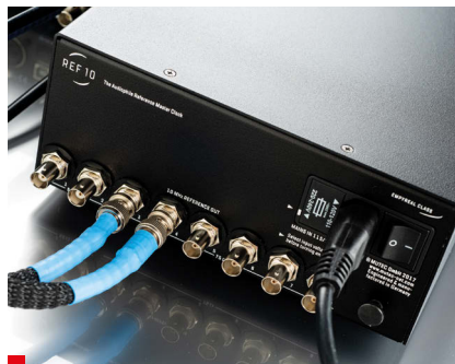
Ref10 ma 6 wyjść zegarowych 10 MHz o impedancji 75 \Omega i dwa 50-omowe.
